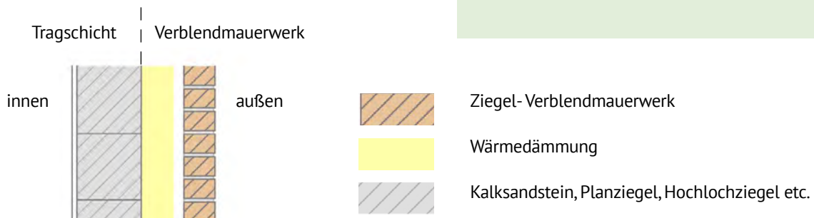
Abb. 173: Vertikalschnitt Mauerwerkswand. Quelle: BuGG
