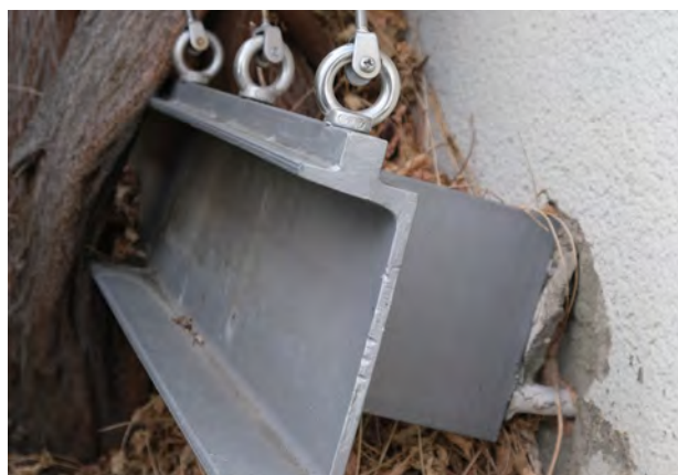
Abb. 93: Herausgerissene Verankerung an einer starkschlingenden Pflanze (Wisteria, Blauregen) aufgrund eines zu geringen Abstandes der Kletterhilfe zum Boden und fehlenden Einrichtungen zur Lockerung der vertikalen Seile. Quelle: BuGG
